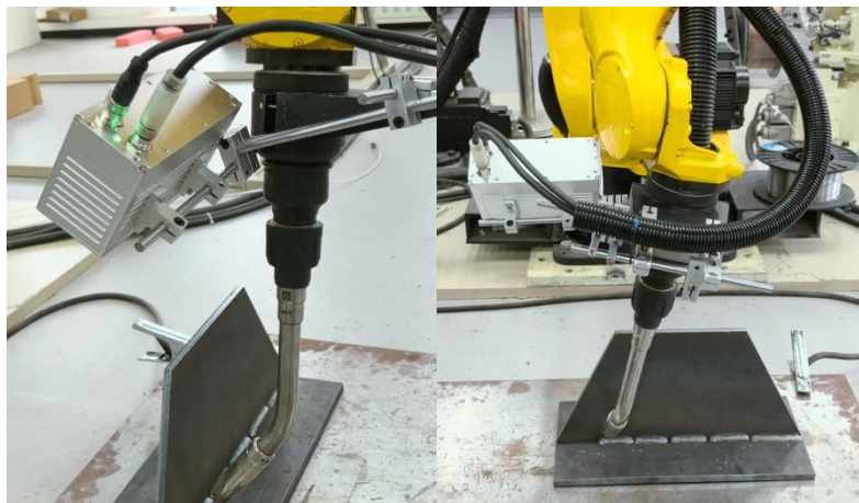
图 5-12 熔缝双测相机安装示意图
