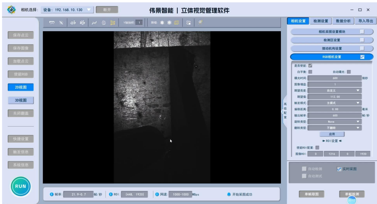
图 6-28 打开熔池监测功能后采图效果
