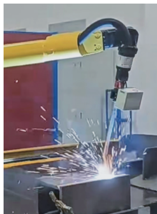
多层多道焊接
