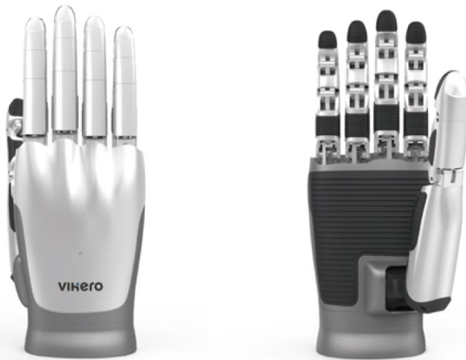
智能灵巧手按照真实人手1:1设计，拥有16个自由度和16个手部关节，高度模拟真实人体手部结构，可完成各种复杂抓握动作和手势展示。控制系统采用电流反馈控制方法，可根据物品的材质和重量智能调节抓力的大小，单指指尖压力可达12N。智能灵巧手和伟景立体视觉智能系统集成后，视觉系统可以通过手部装配的2个的Mark点实时定位、追踪手掌的空间位置和移动路径，进而实现智能灵巧手在各种复杂环境下物品的取放和搬移动作。
