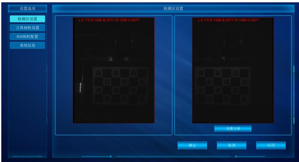
立体相机设置：在相机设置模块，点击“立体相机设置”分别修改曝光时间和增益完成图像亮度设置。
