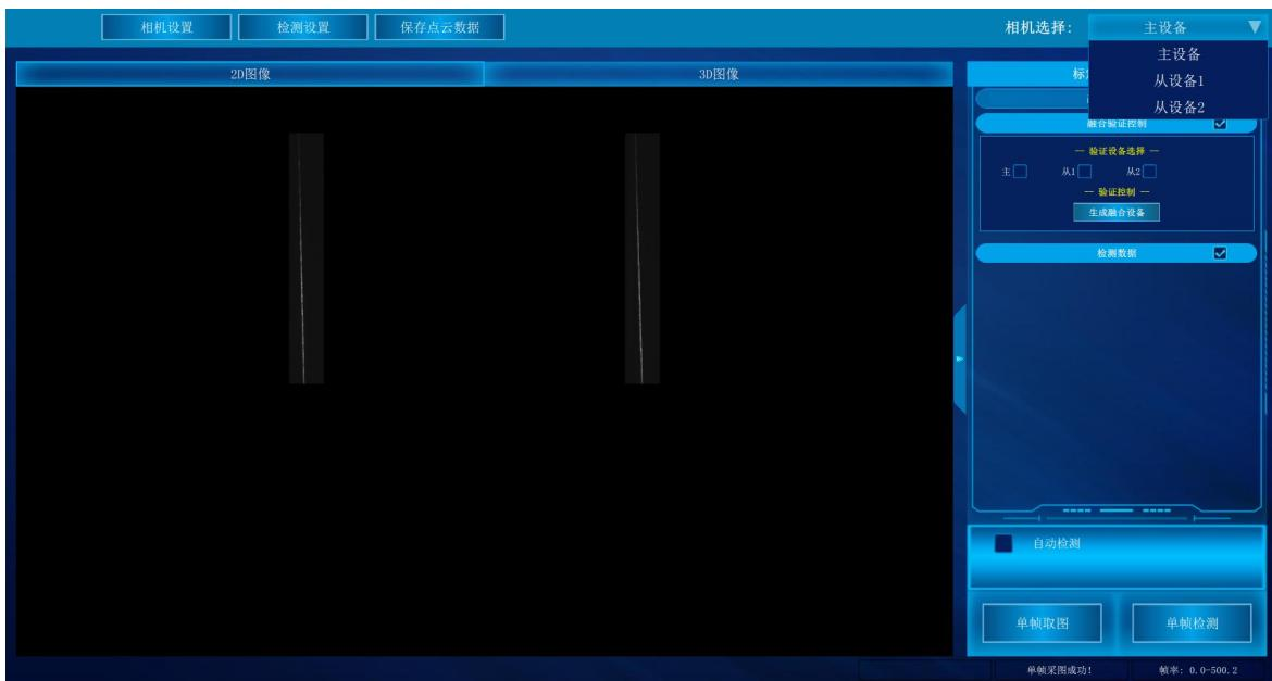
检测区域设置：在主界面，依次点击“相机设置”>“检测区域设置”>“设置全图”。
