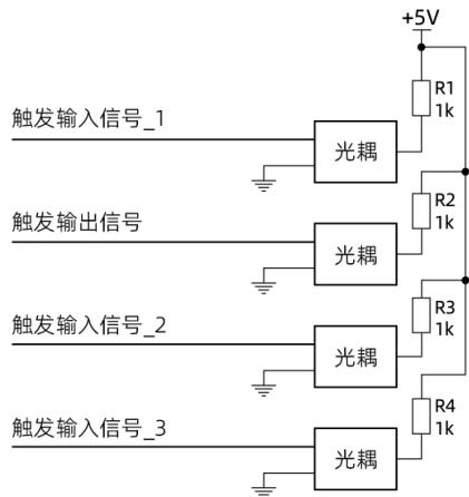
图 2-3 硬触发连接原理图
