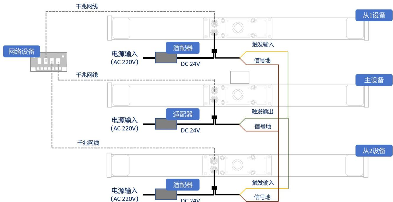
图 2-2 多眼融合线缆连接示意图
