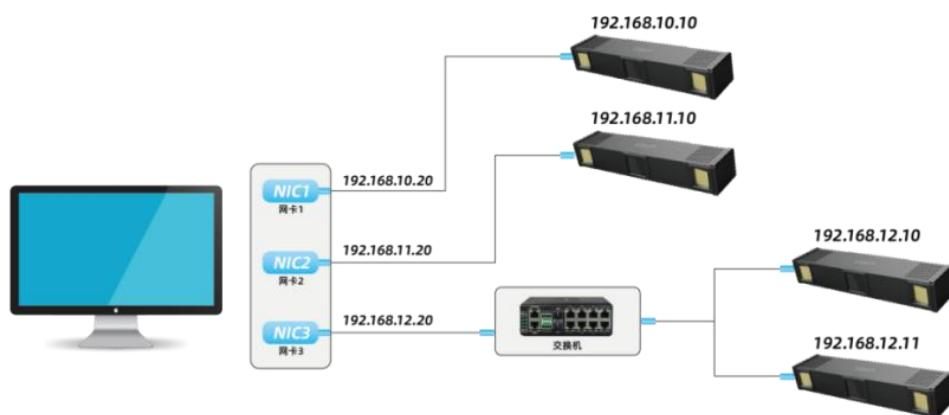
图 3-2 多相机连接示例
