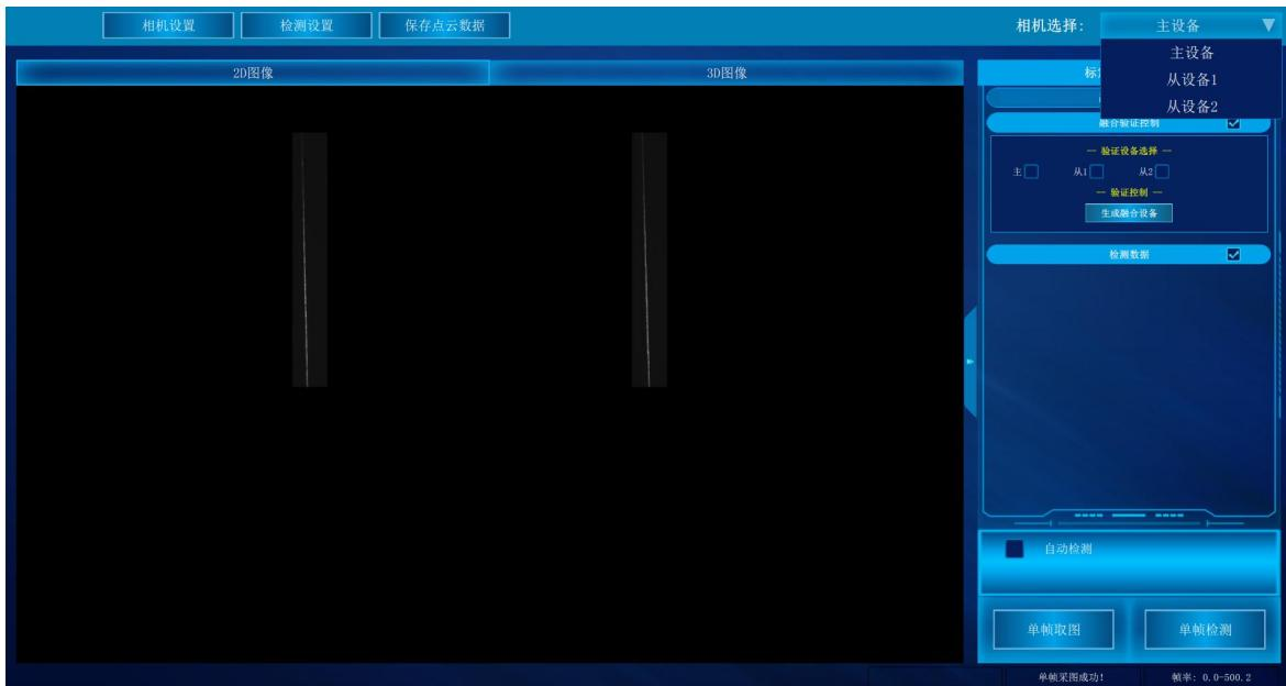
检测区域设置：在主界面，依次点击“相机设置”>“检测区域设置”>“设置全图”。
