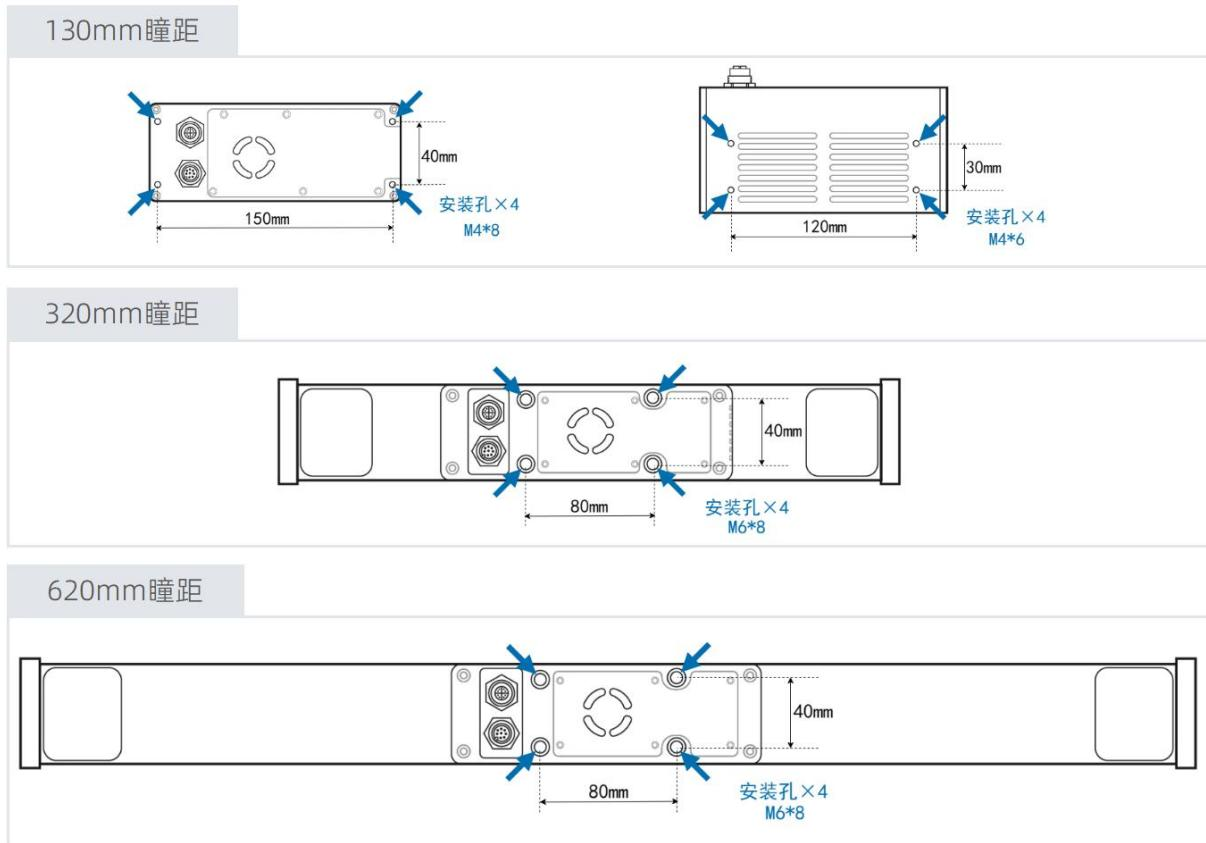
图 1-3 相机安装孔位置示意图
